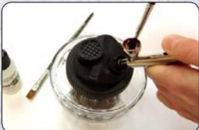
**Zwischenreinigung:** Farbe ausspritzen, Reste mit Wasser und/oder geeignetem Reinigungsmittel und Pinsel/Wattestäbchen lösen und ausspritzen.
