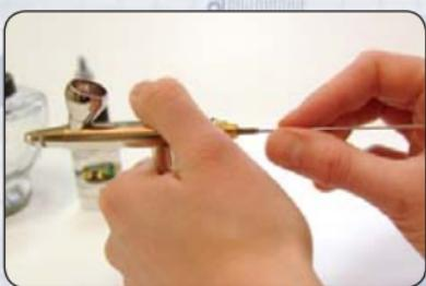
**5.** Rimuovere l'ugello (C) e spingere fuori eventuali residui di colore utilizzando un pennello molto sottile o un ago (I). Controllare che l'ugello o la guarnizione non siano deformati o danneggiati.
