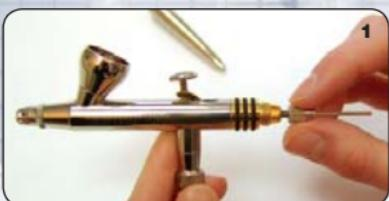
**Gründliche Reinigung (vor längeren Arbeitspausen):** 1. Druckluftzufuhr beenden. Endstück (L) und Nadelklemmutter (K) abschrauben.
