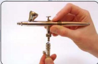
Collegare lo strumento con un attacco filettato\* o un raccordo ad attacco rapido NW 2,7 mm\* o un flessibile\* ad un compressore appropriato\*.
