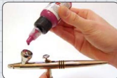
Es sind alle gängigen Airbrush-Farben oder Lacke geeignet, die eine milchähnliche Konsistenz haben. Die Farbe ist ggf. entsprechend zu verdünnen. Die Geräte der Evolution Silverline-Serie sind speziell für die Verwendung von lösemitteltartigen Produkten konstruiert.
