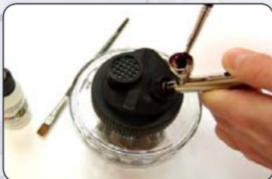
**Tussentijdse reiniging:** de verf opgebruiken, de resten met water en/of een geschikt reinigingsmiddel en een penseel of wattenstaafje oplossen en verstuiven.
