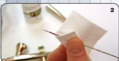
**Nettoyage approfondi (avant toute pause d'utilisation prolongée):** 1. Stopper l'arrivée d'air comprimé. Dévisser la queue (L) et le contre-écrou de l'aiguille (K).
